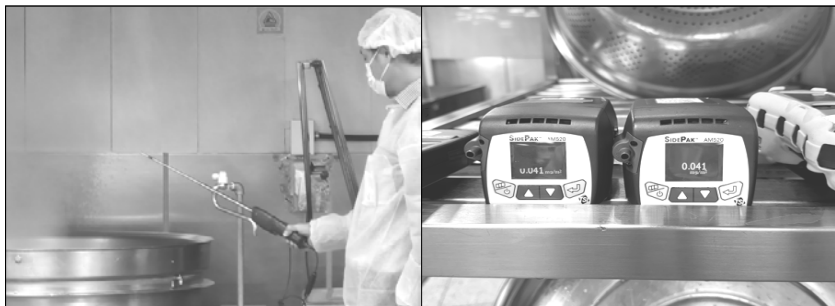
[그림 5-8] 직독식 장비(좌 : 온습도, 우 : 미세먼지)를 이용한 측정 예
